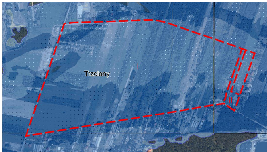
Mapa 11 Mapa zagrożenia powodziowego wraz z głębokością wody. Obszary narażone na zalanie w przypadku zniszczenia lub uszkodzenia wału przeciwpowodziowego
