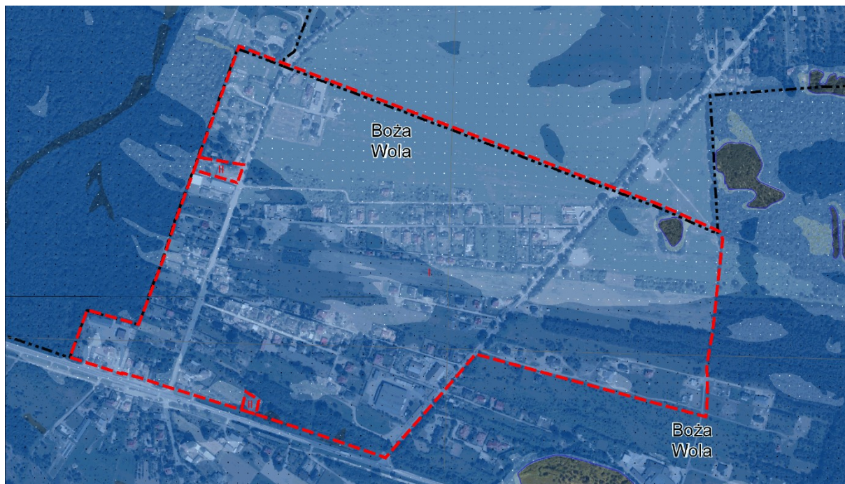
Mapa 8 Mapa zagrożenia powodziowego wraz z głębokością wody. Obszary narażone na zalanie w przypadku zniszczenia lub uszkodzenia wału przeciwpowodziowego
